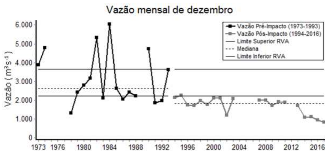
Figura 107. Série temporal da vazão mensal de dezembro do Rio São Francisco no município de Pão de Açúcar antes e depois da construção do reservatório de Xingó.
