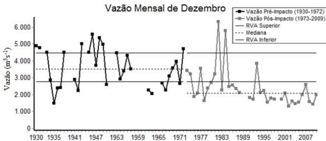
Figura 60. Série temporal da vazão mensal de dezembro do Rio São Francisco a jusante da barragem de Sobradinho antes e depois da construção do reservatório.
