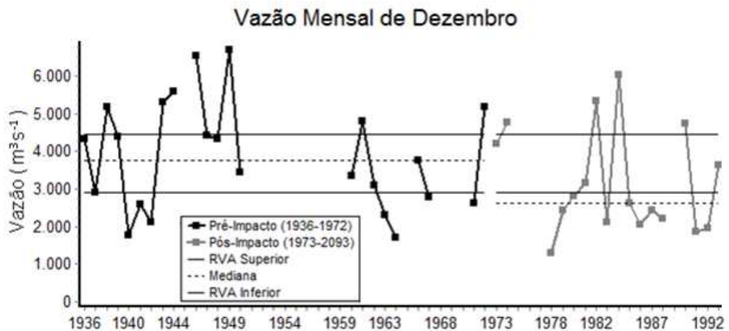
Figura 79. Série temporal da vazão mensal de dezembro do Rio São Francisco no município de Pão de Açúcar antes e depois da construção do reservatório de Sobradinho.
