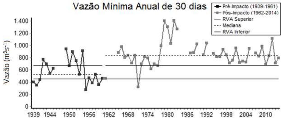
Figura 35. Série temporal da vazão mínima de 30 dias, a cada ano, do Rio São Francisco a jusante da barragem de Três Marias antes e depois da construção do reservatório.
