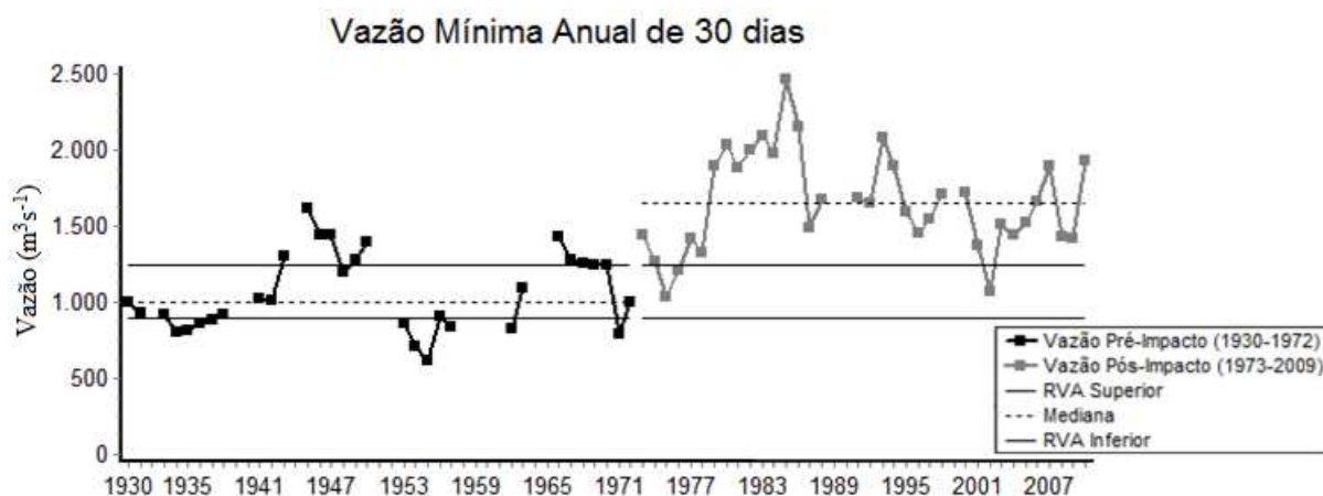
Figura 64. Série temporal da vazão mínima anual de 30 dias, a cada ano, do Rio São Francisco a jusante da barragem de Sobradinho antes e depois da construção do reservatório.
