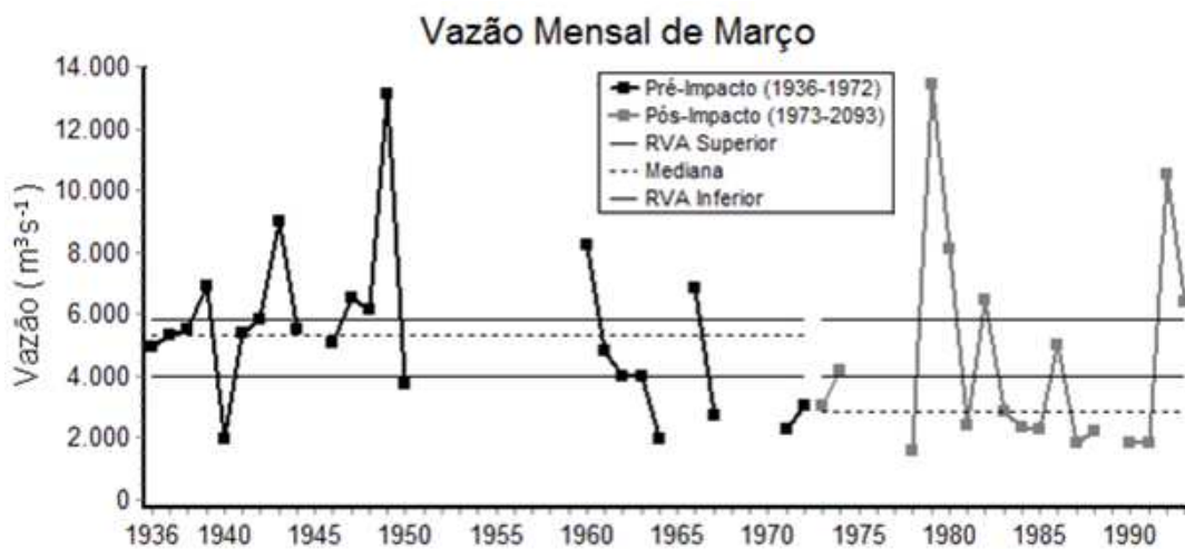
Figura 82. Série temporal da vazão mensal de março do Rio São Francisco no município de Pão de Açúcar antes e depois da construção do reservatório de Sobradinho.
