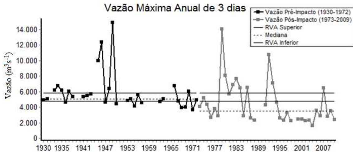
Figura 67. Série temporal da vazão máxima anual de 3 dias, a cada ano, do Rio São Francisco a jusante da barragem de Sobradinho antes e depois da construção do reservatório.
