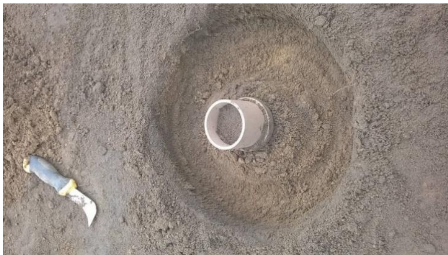
Figura 5. Coleta física das amostras de solo por meio da escavação com facas e armazenamento da estrutura original do solo em cilindro de PVC para posterior tomografia
